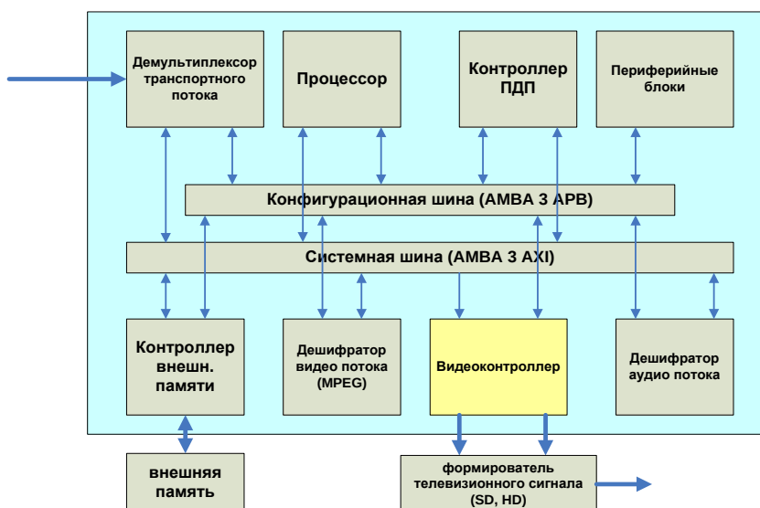
Рисунок 26 - Схема типового применения (в типовом применении обязательно наличие видеоконтроллера, контроллера памяти, процессора, а также шин AXI и APB)
