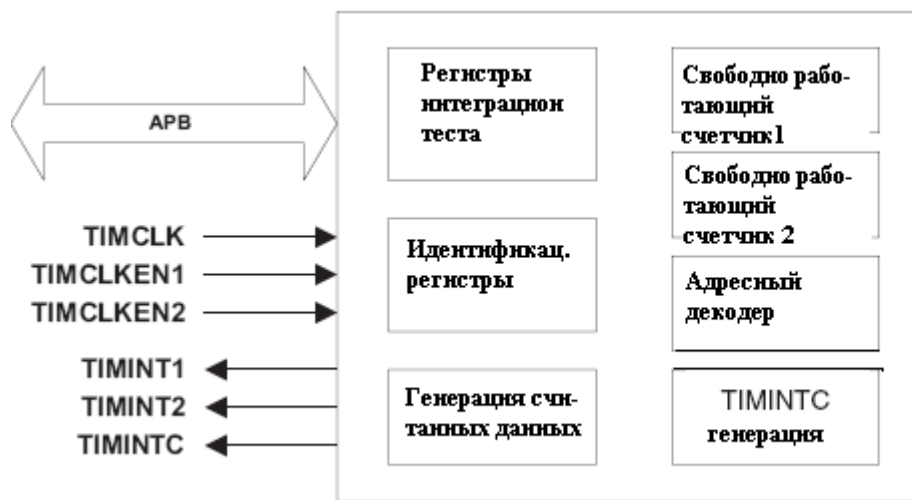
Рисунок 15 – Блок схема двоянных таймеров с входами
