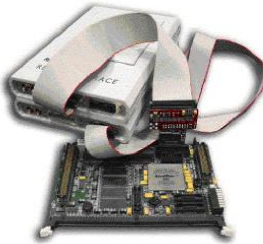
Рисунок 11 – Комплект модулей трассировки и отладки RealView ICE и RealView Trace
